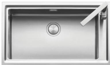
acciaio inox AISI 304 di spessore elevato vasca raggio "15" dimensione vasca: 71x40x21,5 h dotazioni: pilettoni 3" ½, copripilettoni in acciaio inox, troppo-pieno con scarico perimetrale foro rubinetto: 1 foro di serie, 2° foro su richiesta base inserimento vasca: 90 incasso: 84x49 cm filotop: v. scheda tecnica
